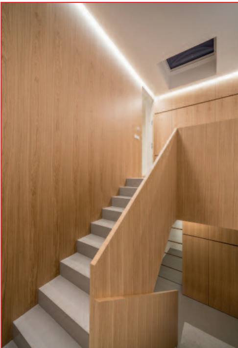
Für die Beleuchtung wurden eigens LED-Profile erstellt, um auch die Installation perfekt und scheinbar unsichtbar in die Architektur integrieren zu können.
